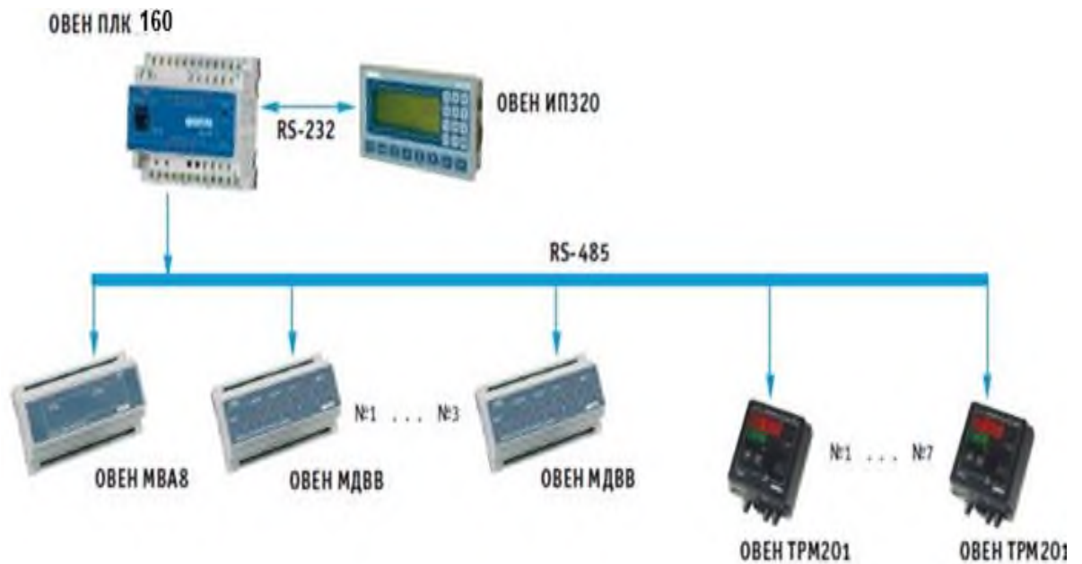
Рисунок 21 – Схема підключення периферійних пристроїв
